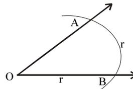
Luego;  $\text{ángulo} = \text{arco dividido el radio}$ .  $\theta = \frac{AB}{r}$
