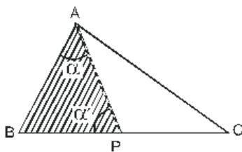
D) Se sabe por hipótesis que  $\overline{BC} > \overline{AB}$ , luego podemos dibujar el lado menor sobre el lado mayor, a partir del vértice B, resultando el punto P interior al segmento BC y además:  $\overline{AB} = \overline{BP}$
