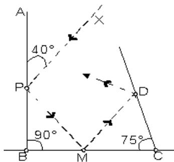
En la figura,  $\hat{B} = 90^\circ, \hat{C} = 75^\circ$  y el rayo de luz forma un ángulo de  $40^\circ$  con AB. Completar la trayectoria del rayo de luz cuando se refleja sobre BC, sobre DC y de nuevo sobre AB. ¿Según qué ángulo se refleja sobre AB el rayo de luz la segunda vez?
