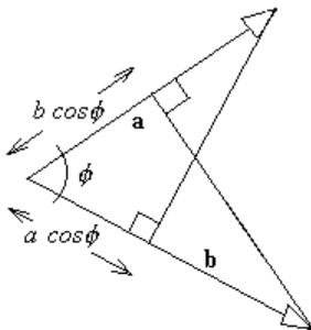
Fig. 6-11: El producto escalar  $\mathbf{a} \bullet \mathbf{b} = a b \cos \phi$  es el producto de la magnitud de cualquiera de los vectores (digamos el  $\mathbf{a}$ ) por la componente del otro vector en la dirección del primer vector (digamos  $b \cos \phi$ )
