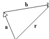
Las reglas que deben seguirse para efectuar esta adición (vectorial) geoméricamente son las siguientes: en un diagrama dibujado a escala se traza el vector desplazamiento **a**; después se traza **b** con su origen colocado en la punta de **a**,
