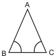
Se constatará entonces, que estos dos ángulos son iguales. Esta comprobación puede efectuarse en cualquier triángulo isósceles; en consecuencia puede generalizarse, aceptando el siguiente postulado:
