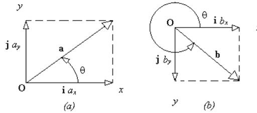
Fig. 6-7: Dos ejemplos de descomposición de un vector en sus componentes vectoriales en un sistema de coordenadas dado; compárese con la Fig. 6-5.
